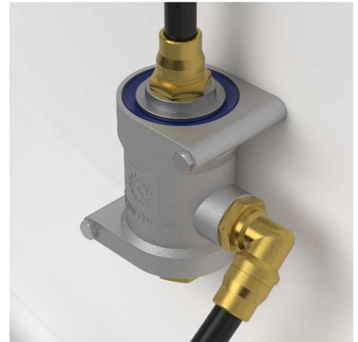
Für beste Ergebnisse sind die gewünschten Gewindeanschlüsse an der Felge G1/2“ (minderst Gewindeabmessung) oder G3/4“. Optional können Sie zwischen Radventil und Felge ein Kugelhahn (ohne Griff) einbauen, um den Reifen auch beim Ein-/Ausbau des Felgenventils unter Druck zu halten.
