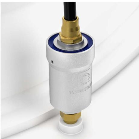
Das Radventil ist ein druckluftdruckabhängiges Ventil, das dafür sorgt, dass der Reifen bei niedrigen Drücken aufgepumpt wird und bei hohem Druckluftdruck umschaltet, sodass der Reifen Luft ablassen kann. Um das Befüllen so schnell wie möglich zu gestalten, können Sie mit zwei voreingestellten Drücken arbeiten: 4 bar oder 6,5 bar. Durch den höheren Fülldruck können Sie problemlos 20 Sekunden Füllzeit einsparen.
